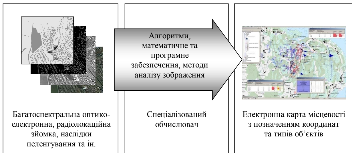
Рис. 1. Принцип аналізу даних в системі ЗОРІ
