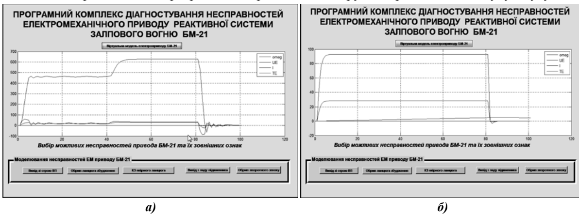
Рис. 8. Діаграми зміни кутової швидкості, напруги та струму в момент пуску електромеханічного приводу: а) справний стан; б) критичний стан (за обриву ланцюга збудження)
