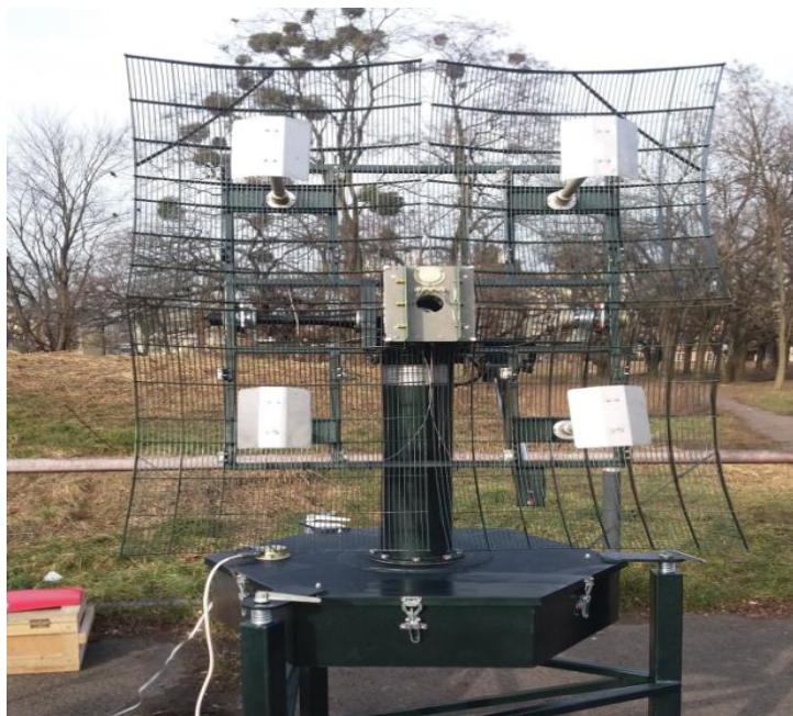
Рис. 5. Блок приймання сигналів та визначення координат радіозонду
